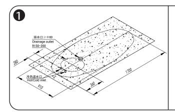
安装施工前,请在地面上布施下水管道, 冷热进水管。图中冷热水管的尺寸,请 按具体施工时浴缸边缘距墙面的距离确
