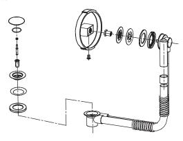
7、安装排水管:依排水管的安装说明书将排水管安装在浴缸上。下图是推荐使用的我司排水管P9098N的安装图例。
